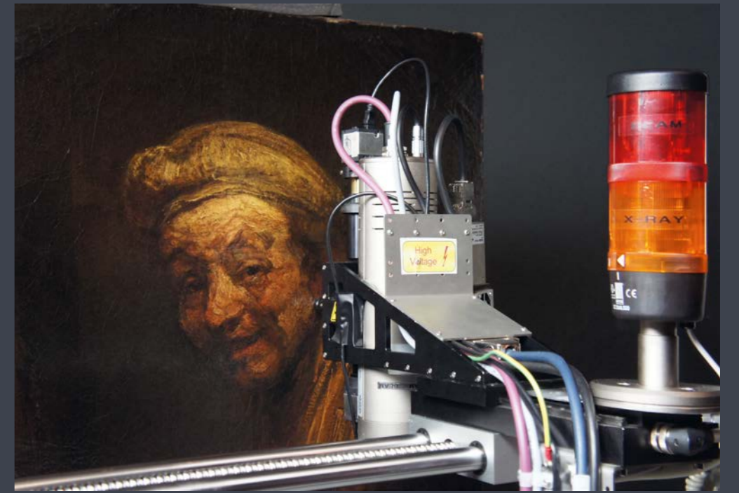
Das minutiöse Scan-Verfahren der Röntgenfluoreszenz-Analyse wird hier an Rembrandts spätem Kölner Selbstbildnis (vgl. S. 194, Abb. 125) eingesetzt.
